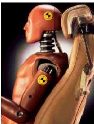
Ejemplos de sistemas de apoyacabezas activos
