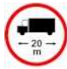
Prohibido circular vehículos de longitud mayor que la indicada
